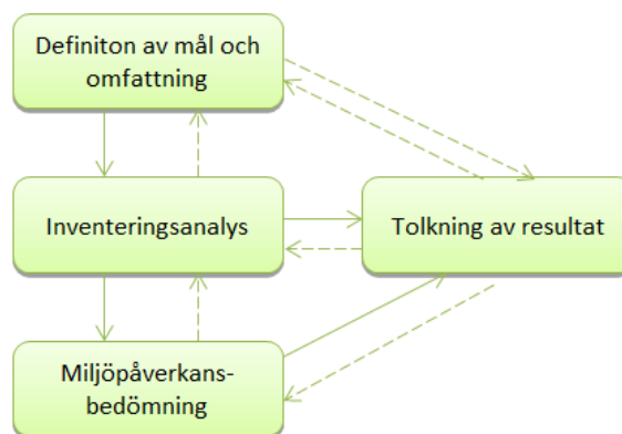
Figur 2 Översikt av LCA-proceduren. Pilarna indikerar i vilken ordning de olika stegen utförs. Streckade pilar indikerar möjliga iterationer. (Anpassad från Baumann and Tillman, 2004).
